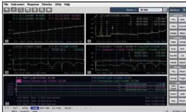
Кроме измерения S-параметров при определении характеристик усилителя с диапазоном частот от 10 МГц до 125 ГГц используются следующие программные приложения: анализатор спектра, измерение компрессии в панорамном режиме и измерение параметров дифференциальных и I/Q-устройств.
