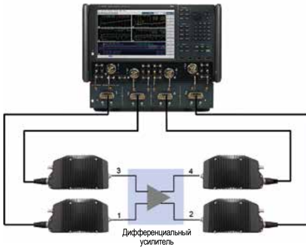
Измерение параметров балансного усилителя напряжения, управляемого током, с использованием реальных дифференциальных сигналов с помощью 4-портового анализатора цепей серии PNA, контроллера N5292A и модулей расширения частотного диапазона N5293A.
