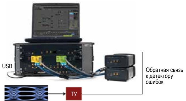
Сигналы PAM-4 и NRZ; 1- или 2-канальный генератор кодовых последовательностей с выносными головками, коррекция предсказаний и внесение джиттера
