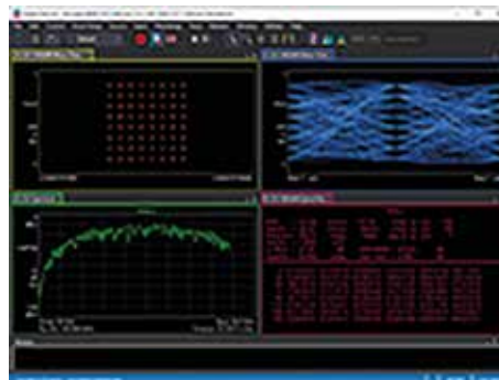
Сигнал QAM-64, генерируемый на скорости 16 Гбод на несущей 39 ГГц
