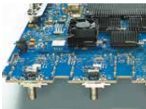
Малюшмящие входные каскады и корректирующие фильтры обеспечивают равномерную частотную характеристику
