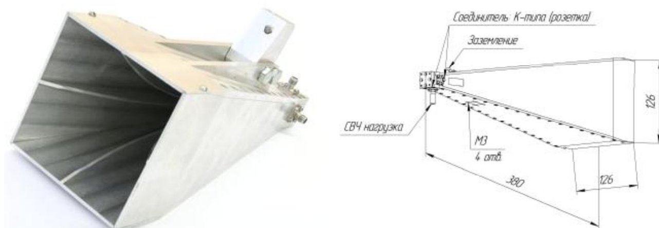
Рисунок 5 - Фотография внешнего вида (слева), места пломбировки от несанкционированного доступа и нанесения знаков утверждения типа (справа) антенны ПБ-129
