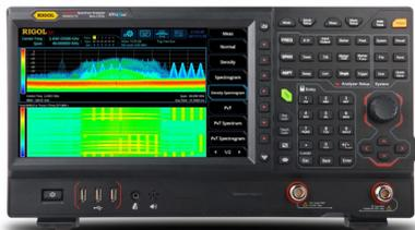
Компания Rigol выпустила **анализатор спектра реального времени с встроенным трекинг-генератором RSA5032-TG**. Это высокопроизводительный измерительный прибор Hi-End класса, разработанный для решения задач, требующих высокую точность измерений. Данный анализатор позволяет удобно и быстро проводить измерения благодаря низкому уровню фазовых шумов, широкой полосе анализа и функционалу, который включает сразу нескольких приборов, таких как:
