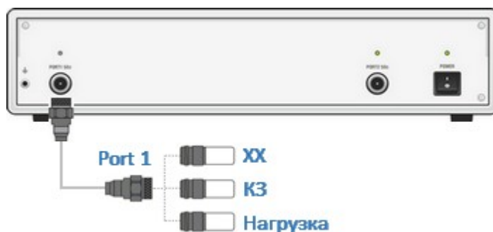
Рисунок – Полная однопортовая калибровка
