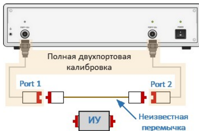
Рисунок – Второй этап калибровки с неизвестной перемычкой SOLR
