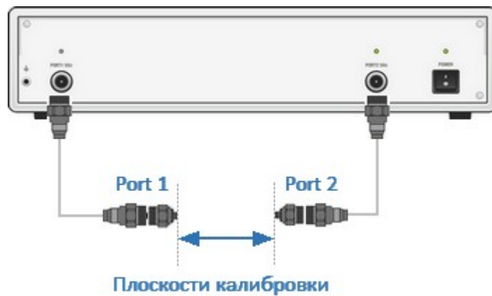
Рисунок – Пример плоскостей калибровки
