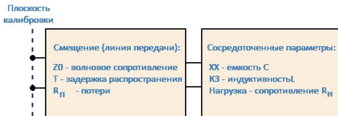
Рисунок – Модель однопортовой меры
