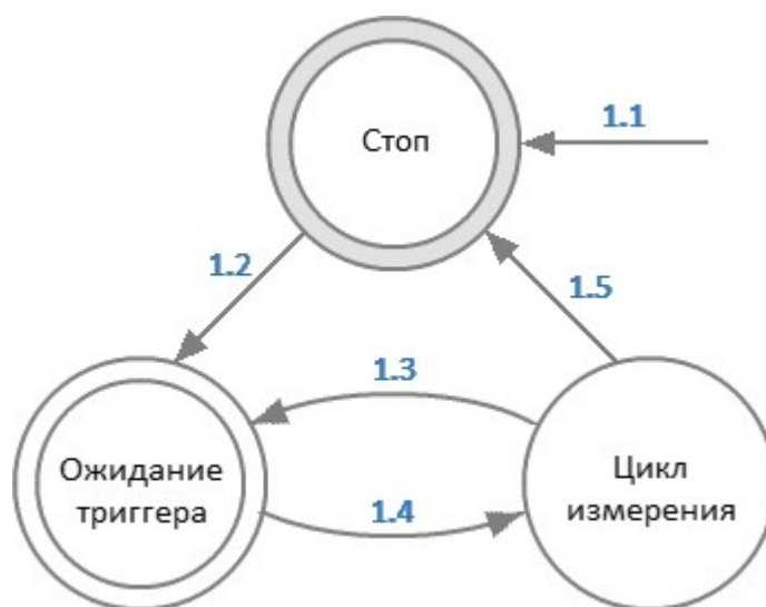
Рисунок — Состояния и переходы анализатора
