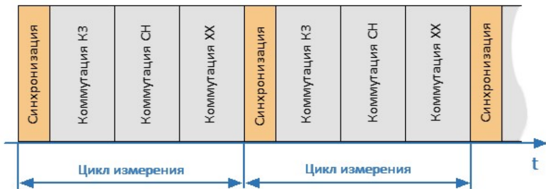
Рисунок – Временная диаграмма рабочего цикла модуля
