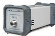
Для реализации полной гальванической развязки, РММ 9030 и РММ 9060 питаются от той же самой сменной литий-ионной перезаряжаемой батареи устройства 9010, обеспечивая полную взаимозаменяемость и работу без шумов непрерывно в течение 4 часов. Замена сменной батареи занимает всего несколько секунд для повышения производительности труда.
