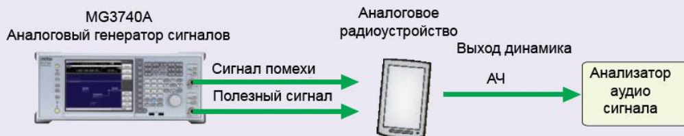
Схема подключения для измерения характеристик аналогового радиоприемника
